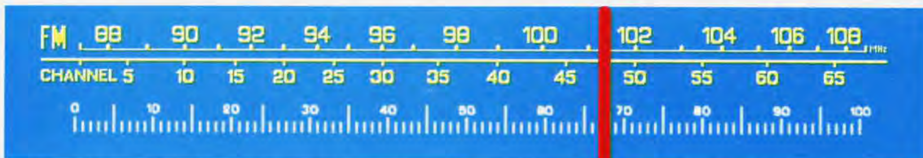
Fig.317 Quando in una radio FM portiamo il cursore sui 101,5 MHz un'altra bobina con in parallelo una diversa capacità si sintonizza su questa nuova frequenza di 101,5 MHz.
