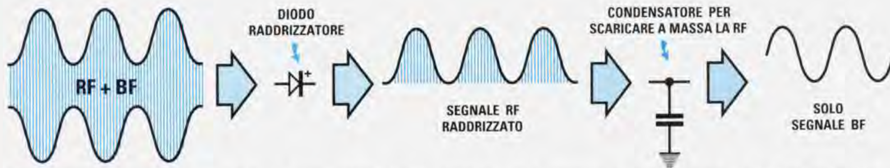
Fig.295 Per prelevare da un segnale RF modulato in Ampiezza il segnale di BF si utilizza un diodo che raddrizza una sola semionda RF con sovrapposto il segnale BF, poi si elimina il segnale RF con un condensatore di piccola capacità. In questo modo si ottiene un segnale di Bassa Frequenza identico a quello usato per la modulazione.
