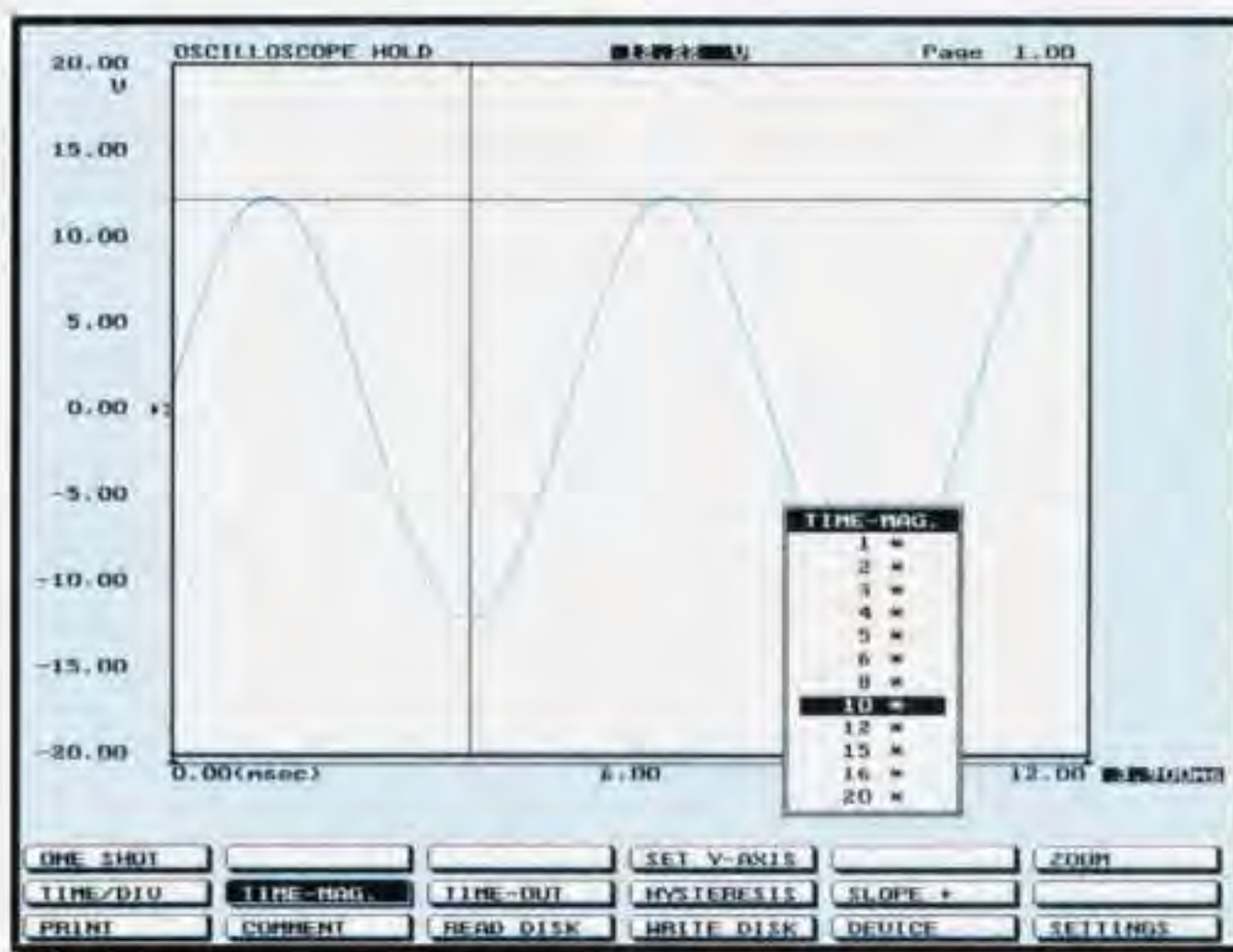
Fig.3 Se volete allargare la sinusoide sullo schermo, portate il cursore sulla casella Time-Mag., premete Enter e nella finestra che apparirà scegliete 10-15-20.
