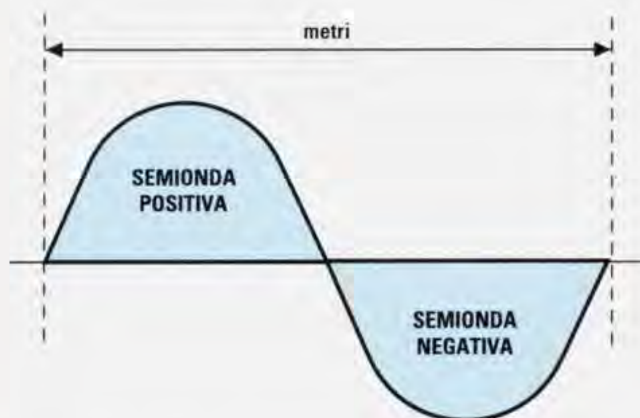
Fig.337 La "lunghezza d'onda" è la distanza in chilometri - metri o centimetri che intercorre tra l'inizio e la fine di una SOLA e completa sinusoide alternata.
