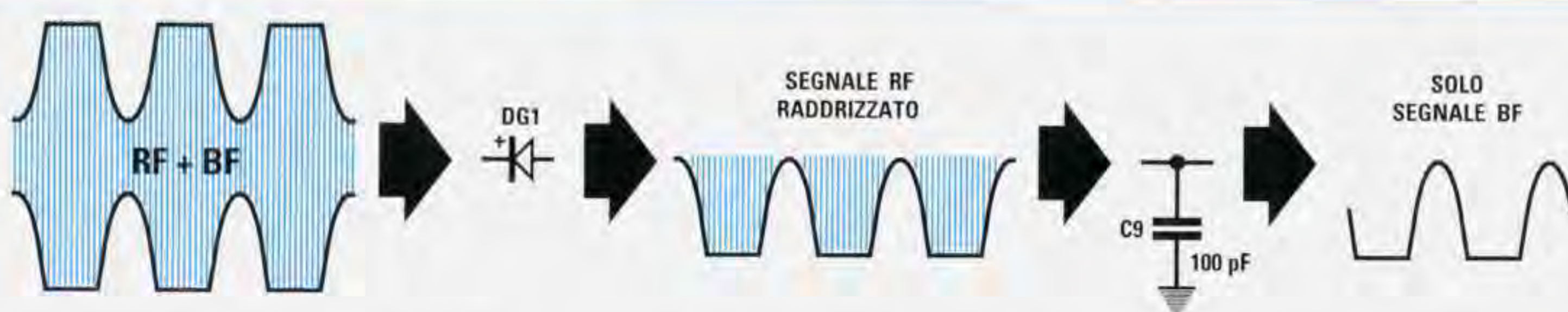
Fig.355 Se in un ricevitore non fosse presente un Controllo Automatico di Guadagno tutti i segnali molto forti saturerebbero gli stadi preamplificatori. In un segnale saturato le estremità del segnale RF+BF verrebbero "tosate" e in tali condizioni il segnale BF raddrizzato non avrebbe più una perfetta forma sinusoidale bensì una forma distorta.
