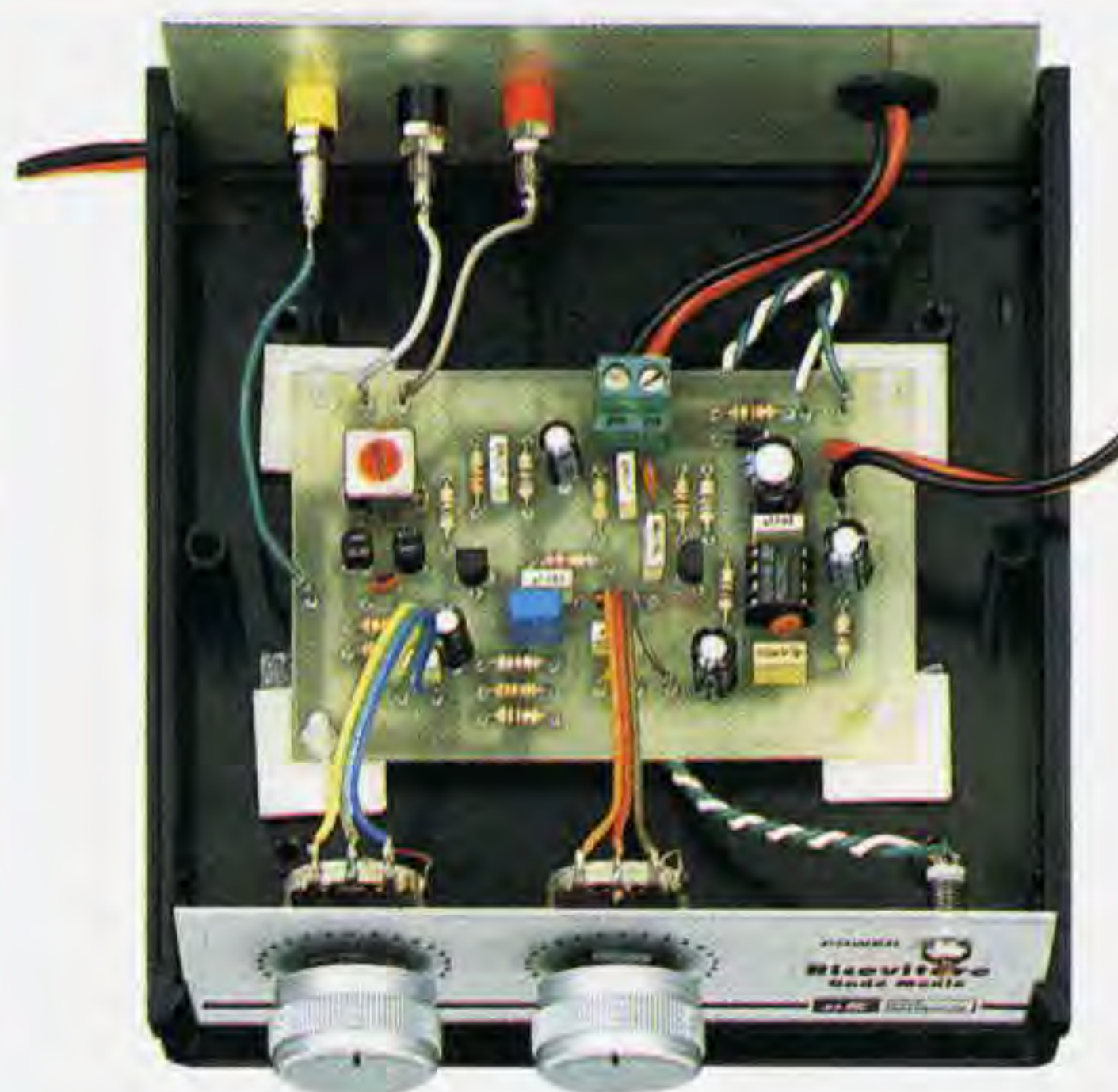
Fig.362 Per fissare la basetta del ricevitore all'interno del mobile, dovrete inserire nei quattro fori presenti nel circuito stampato i perni dei distanziatori plastici che troverete inclusi nel kit.
