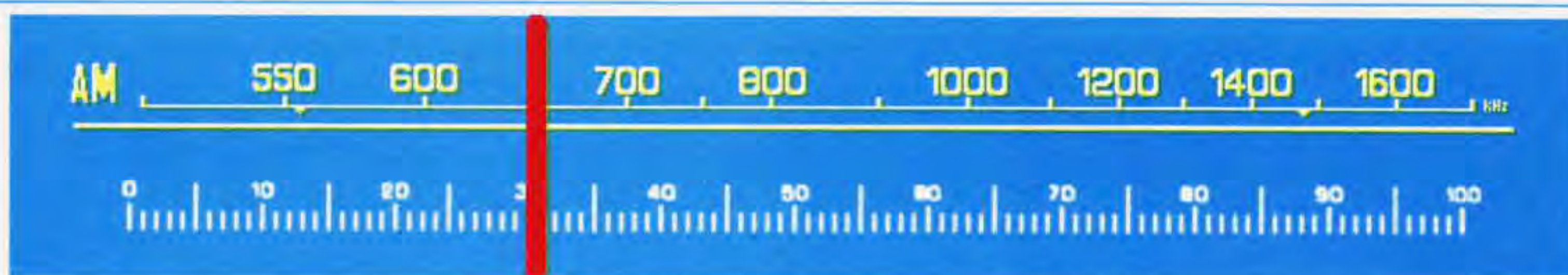
Fig.316 Quando in una radio AM portiamo il cursore sui 650 kHz, internamente un circuito composto da una bobina ed una capacità si sintonizza su questa esatta frequenza.
