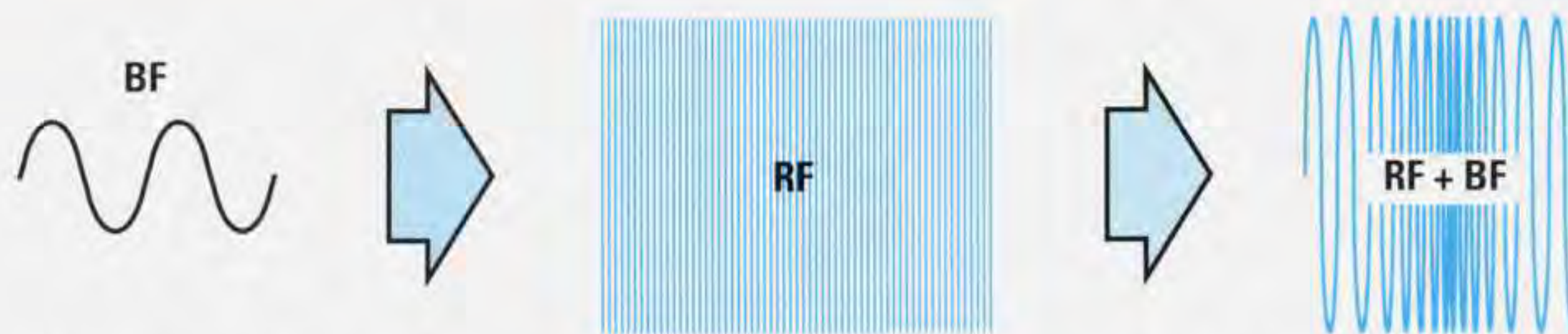
Fig.298 Per modulare in FM un segnale di Alta Frequenza le onde sinusoidali di Bassa Frequenza vengono sommate e sottratte alla "frequenza portante". In questo modo varia la frequenza, ma non la ampiezza. Una frequenza di 90 MHz modulata in FM si sposta da un minimo di 89,98 MHz fino a un massimo di 90,02 MHz.
