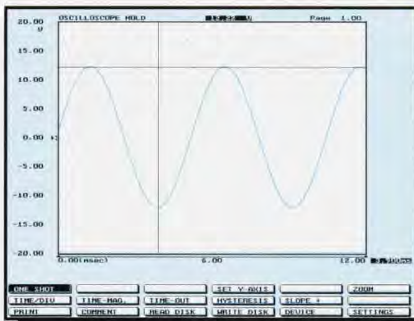
Fig.2 Il segnale apparirà sullo schermo dopo aver portato il cursore sulla casella One Shot e premuto Enter. Per spostare la riga verticale o orizzontale leggere testo.
