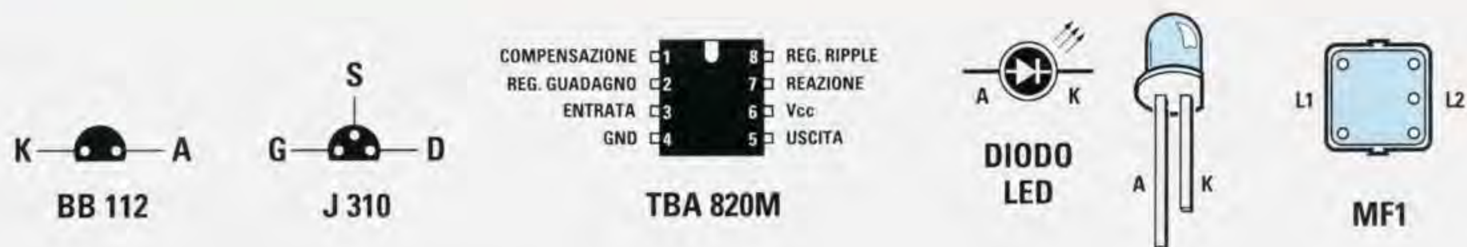
Fig.353 Connessioni dei terminali dei diodi varicap BB.112, del fet J.310 e della Media Frequenza MF1 viste da sotto. Le connessioni del solo integrato TBA.820/M sono viste da sopra. Ricordate che il terminale più lungo del diodo DL1 è l'A ed il più corto il K.
