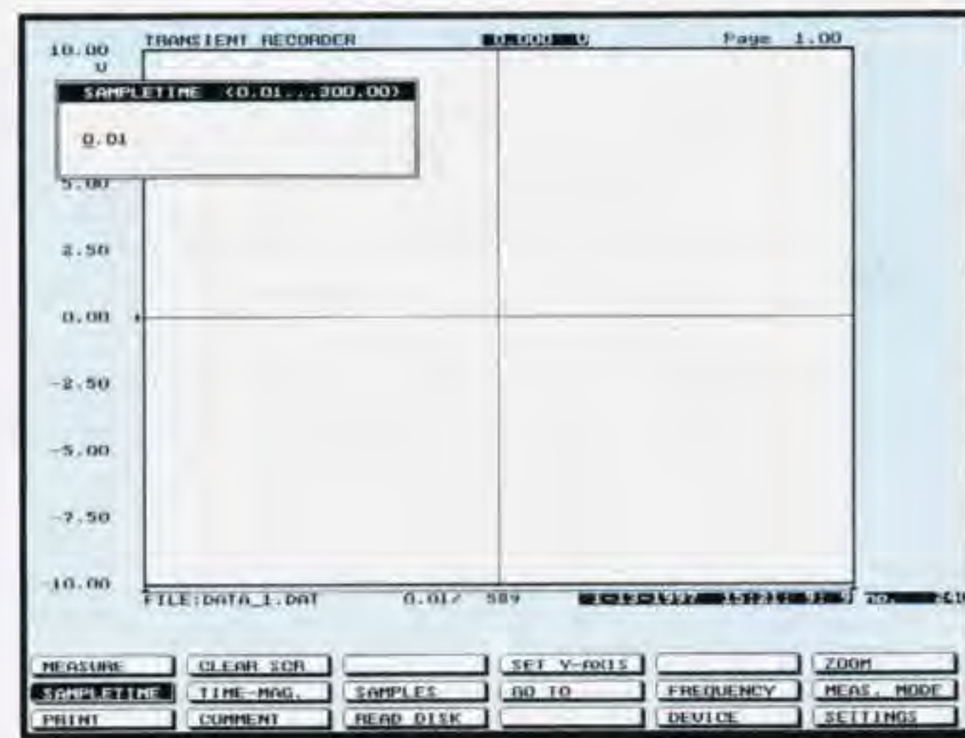
Fig.20 Dopo aver portato il cursore sulla casella posta in basso con la scritta Sampletime, nella finestra che apparirà scrivete il tempo dei campionamenti.
