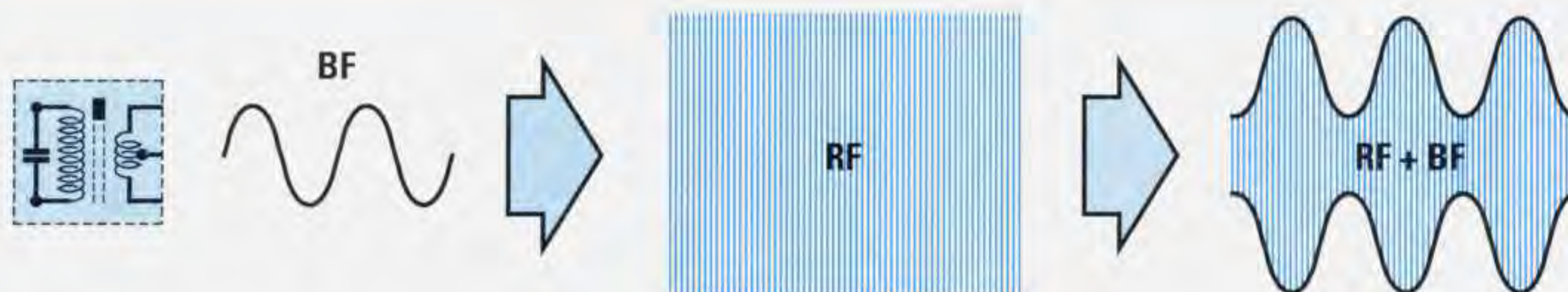
Fig.292 Per modulare in AM un segnale di Alta Frequenza occorre sovrapporre alla sua portante il segnale sinusoidale di Bassa Frequenza. Come potete notare, la sinusoide di BF si sovrappone automaticamente su entrambe le estremità del segnale di Alta Frequenza aumentando così l'ampiezza (vedi disegno a destra).
