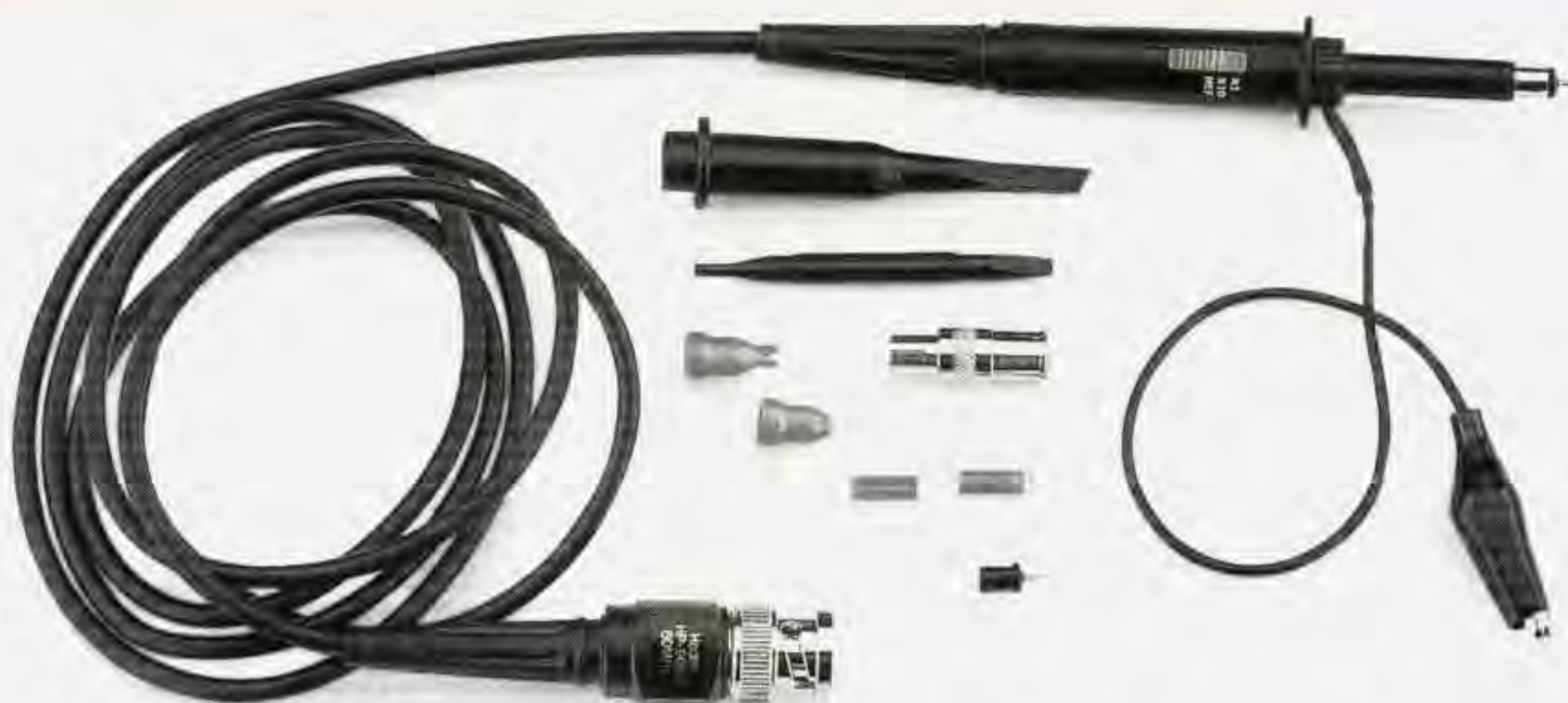
Fig.25 Come abbiamo spiegato negli articoli precedenti, sull'ingresso della sonda non dovreste mai applicare dei segnali che superano i 40 volt picco/picco (20 volt positivi e 20 negativi). Inserendo nell'ingresso il puntale sonda KM01.31 potrete arrivare ad un massimo di 400 volt picco/picco perché provvisto di due attenuatori X1 e X10. Questa sonda completa di tutti gli accessori visibili nella foto, può essere usata anche per oscilloscopi o altri strumenti di misura. Costo del puntale L.62.000 (abbonati L.55.800).
